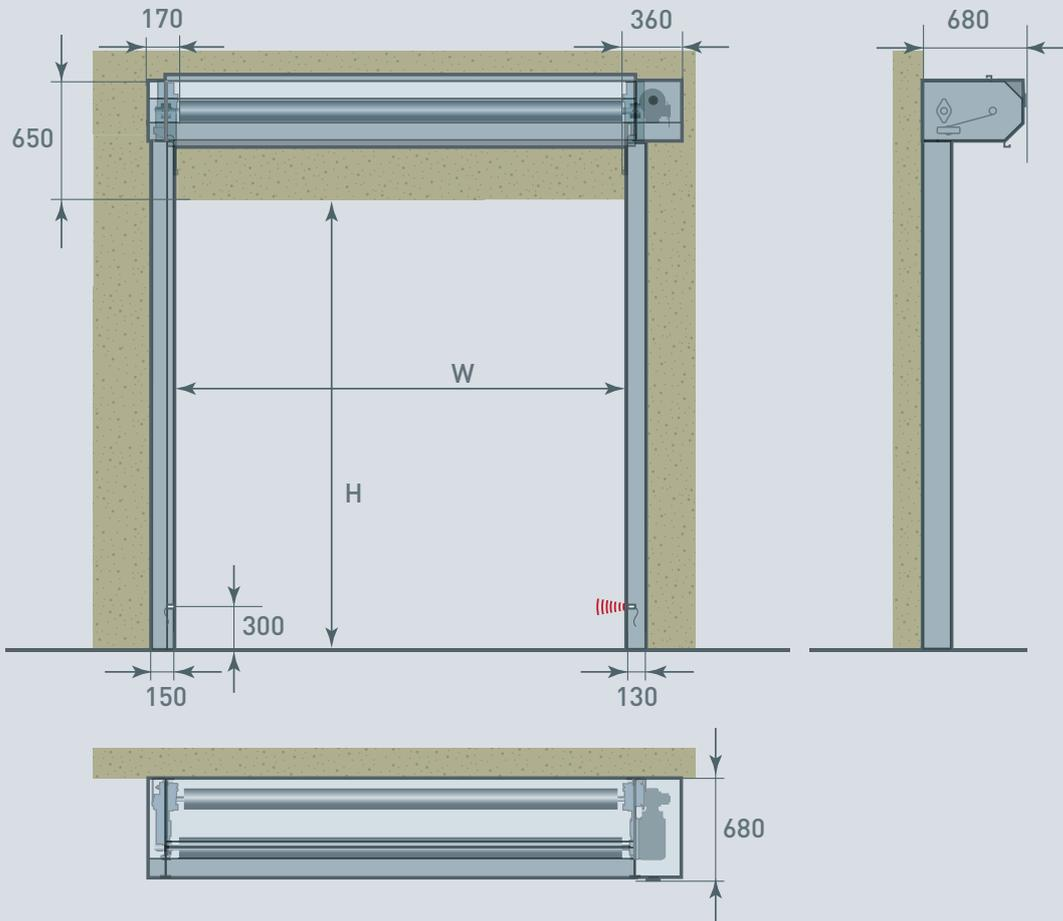
Alle Abmessungen sind netto, der benötigte Platz für Montage und Unterhaltung muss berücksichtigt werden. Achtung: Wellenabdeckung nur verfügbar für Torbreite bis 5900mm.
